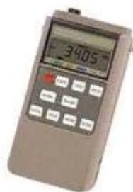
Рисунок 3 - Внешний вид измерителя оптической мощности
