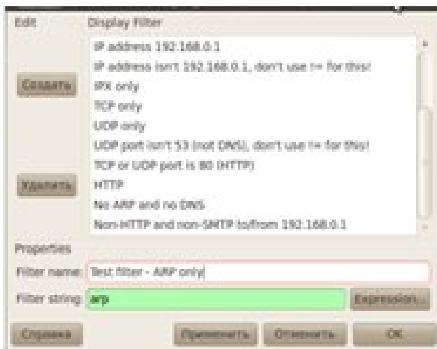
Рис. 8 – Настройка фильтра для анализа ARP-пакетов
