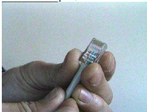
Рис.8. Проверка правильности разводки проводов кабеля.
