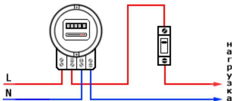
Питающее вводное напряжение подается на клеммы 1 и 3 счетчика, причем фазный провод соединяется с клеммой 1, а нулевой - с клеммой 3. Снимается со счетчика и подключается к нагрузке (электропроводке) напряжение с клемм 2 и 4: с клеммы 2 - "фаза", с клеммы 4 - "ноль".
