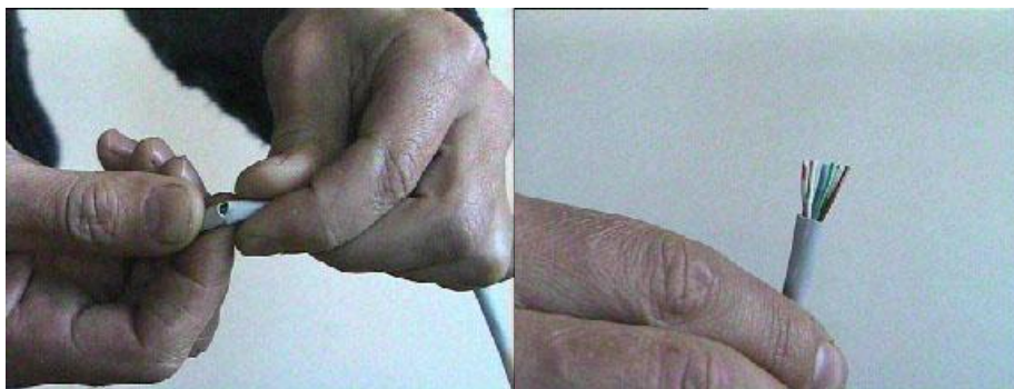
Рис.6. Удаление внешней оболочки с кабеля RJ-45
