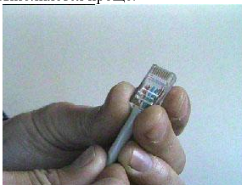
Рис.8. Проверка правильности разводки проводов кабеля.
