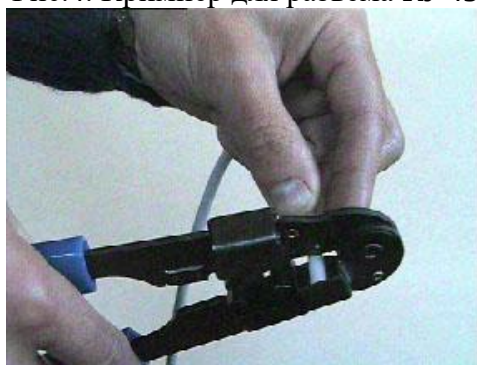
Рис. 5 Обрезка кримпером внешней оболочки кабеля
