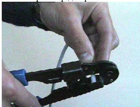
Рис. 5 Обрезка кримпером внешней оболочки кабеля
