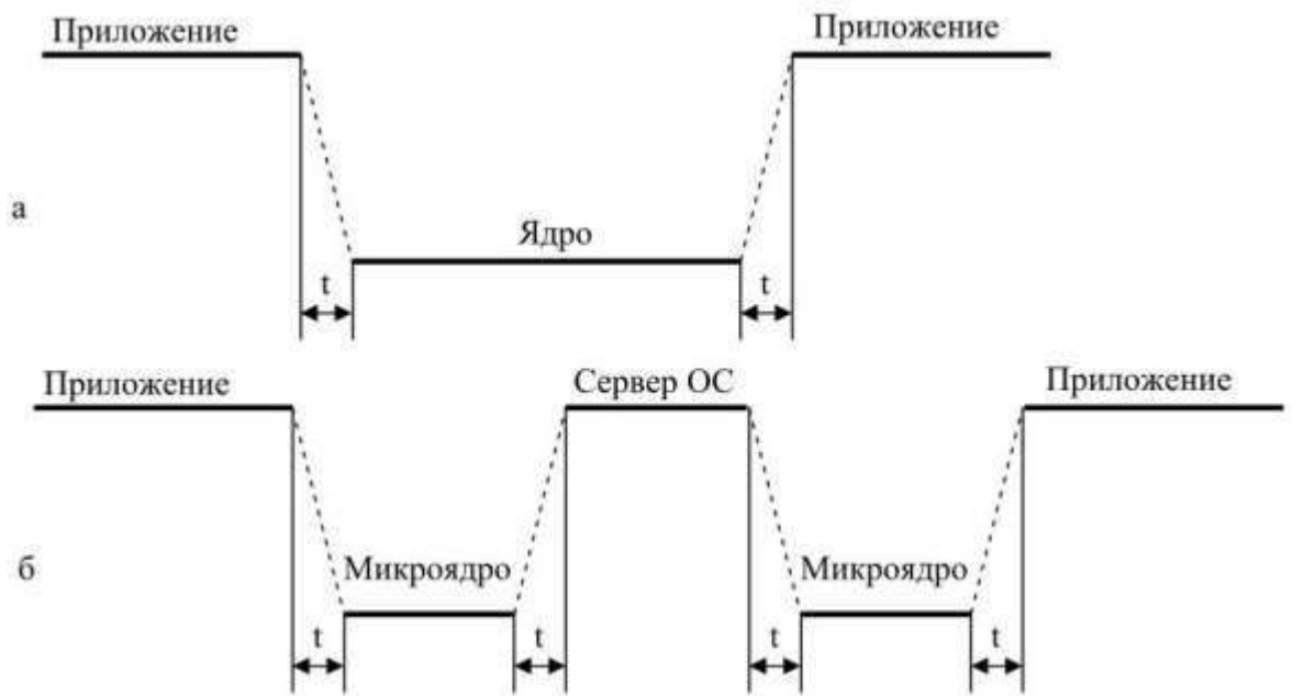
Рисунок 3 – Смена режимов при выполнении системного вызова: в классической архитектуре (а); в микроядерной (б)
