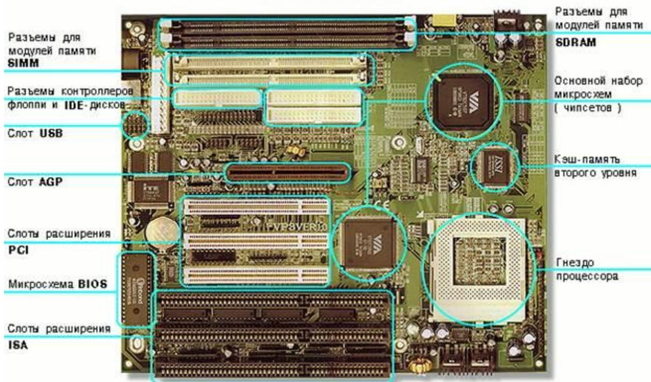
2. Установите местоположение процессора и изучите организацию его системы охлаждения. По маркировке определите тип процессора и фирму-изготовителя.
