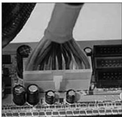
Обычно этого достаточно. Но на некоторых материнских платах (например, с сокетом Intel LGA775) нужно подключить еще 4-контактную колодку ATX12V. Более подробно можно прочитать в руководстве по материнской плате.
