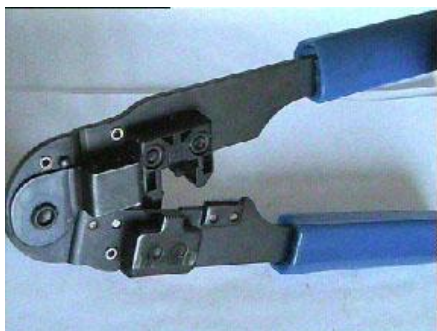
Рис.4. Кримпер для разъема RJ-45
