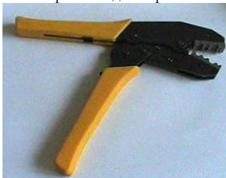
Рис.2 Кримпер для обжимки коаксиального кабеля
