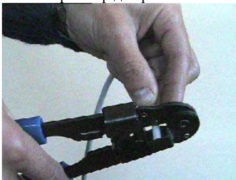
Рис. 5 Обрезка кримпером внешней оболочки кабеля
