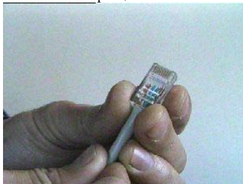
Рис.8. Проверка правильности разводки проводов кабеля.
